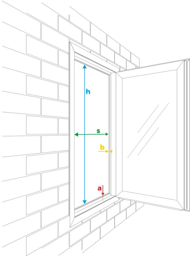
1. Messen der Breite **s** [mm] und Höhe **h** [mm] des Lichtes des Fensterrahmens.
